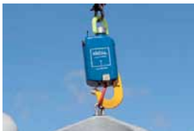
...kroken stängs via fjärrkontroll...
